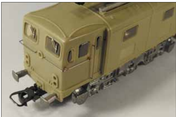
Foto 8: Detail plaatsing handgrepen cabine
